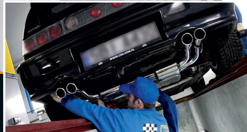
Montaż dedykowanego elementu również nie stwarza problemów i trwa dosłownie chwilę. Wystarczy powiesić tłumik na wieszakach i...
