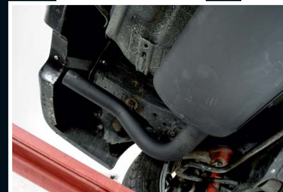
Jedna skromna rura zostanie zastąpiona czterema sportowymi wylotami ze stali nierdzewnej. Podkreślił to jeszcze klasyczny już styl CRX-a
