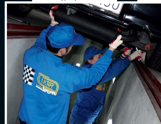
Demontaż nie należy do skomplikowanych i czasochłonnych zajęć. Dodatkowa para rąk przyda się, kiedy odkręcimy tłumik
