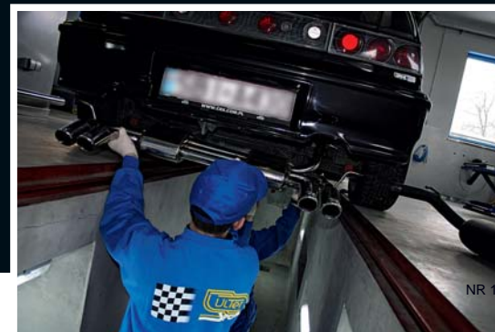
Montaż dedykowanego elementu również nie stwarza problemów i trwa dosłownie chwilę. Wystarczy powiesić tłumik na wieszakach i...
