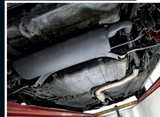
Końcowy odcinek układu wydechowego, czyli tłumik i rura w standardowym wydaniu, za chwilę zostanie zamieniona na sportowy wydech
